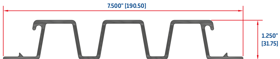
PERFIL P/PISO REFRIGERADOR 9806
