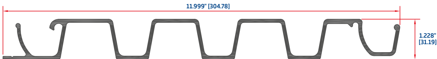
PERFIL P/PISO REFRIGERADOR 9805
