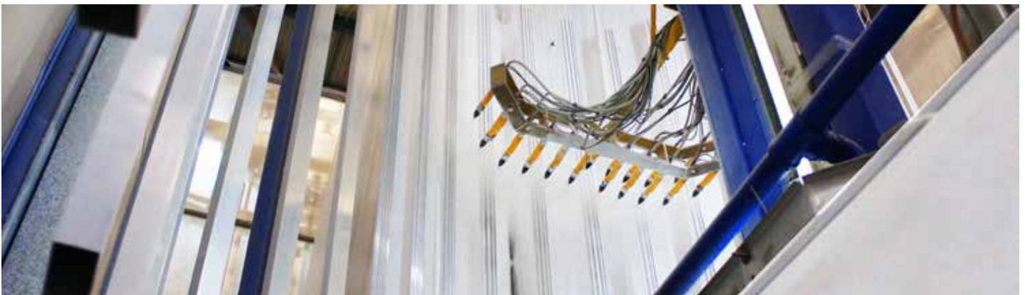
Líneas de pintado con sistemas más recientes y avanzados de pre-tratamiento y pintura electrostática continua.
