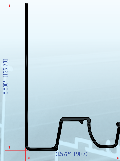
SECCION LATERAL DE PISO CLAVE: 9811
