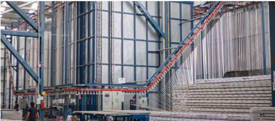
Líneas de pintado una vertical y otra horizontal con los sistemas más recientes y avanzados de pretratamiento y pintura electrostática continua.
