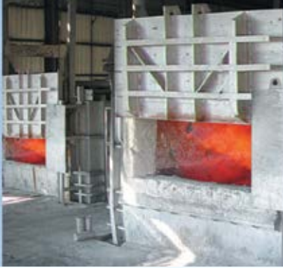
Fundición, vaciado y formado de lingotes cilíndricos para extrusión.
